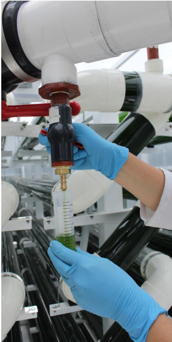
*Figura 35:* Toma de muestra del cultivo para medición de la concentración celular.
