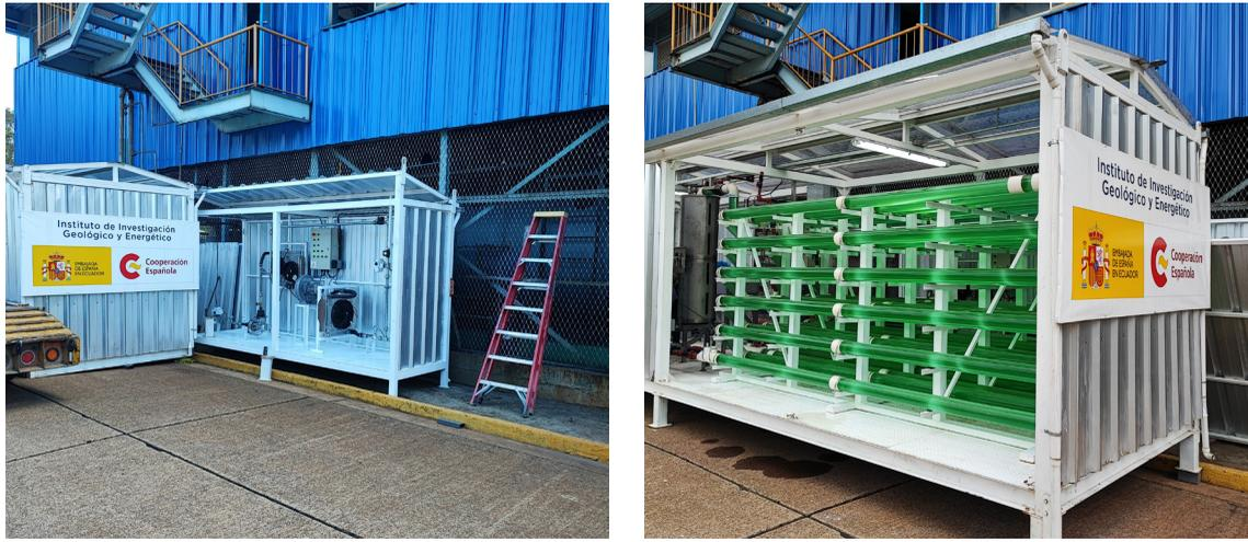
**Figura 42:** Prototipo para pruebas de fijación de CO<sub>2</sub> realizadas en la Central Térmica Gualberto Hernández de la Empresa Eléctrica Quito (EEQ).
