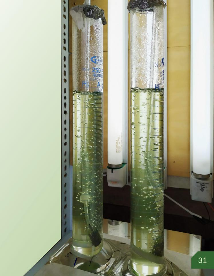
**Figura 14:** Ensayos de optimización, parámetro de estudio: Intensidad de luz, ejecutados en el proyecto “Estudio de captura de carbono para la producción de biocombustibles a partir de biomasa microalgal, *Chlorella Sp*, empleando fotobiorreactores” financiado por la AECID.
